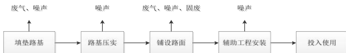
图 2.10-3 道路工程生产工艺流程
