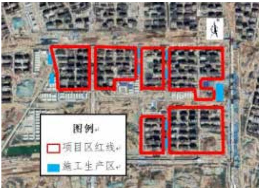
图 2-13 施工生产区布置示意图
